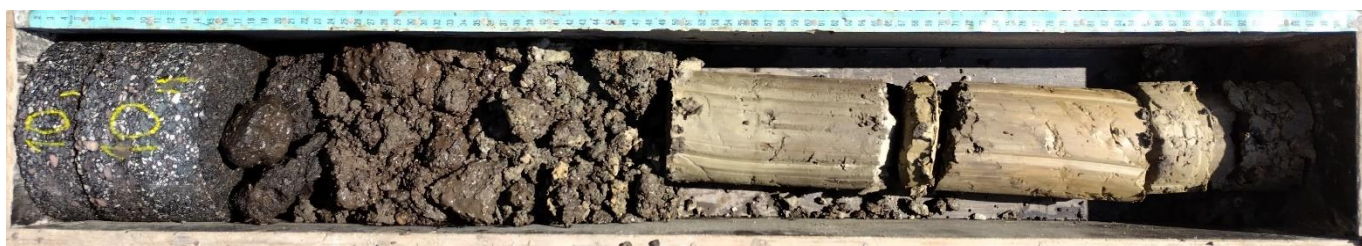
JV10-S10 sonda na stavbě
